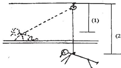
b) dispositivo di arresto di tipo retrattile
