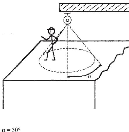
Fig.16 - Limiti operativi del dispositivo anticaduta di tipo retrattile con punto di ancoraggio sopra l'utilizzatore
