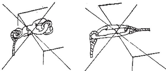
Fig. 23 - Elementi di attacco usati impropriamente
